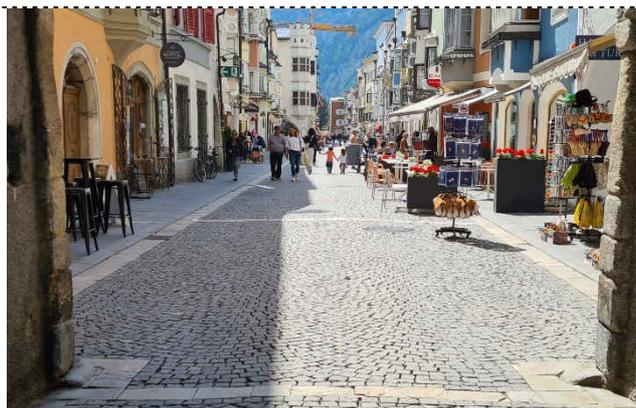
Die Bodenbereiche mit glatten, aber rutschfesten Steinplatten können für Rollstuhlfahrer und ältere Menschen (aufgrund der Stolpergefahr bei Steinpflasterbodenbeläge) sehr gut genutzt werden. Ausserdem können bereits vorhandene Wasserrinnenkanten für Blinde als Leitsystem gut verwendet werden. Diese Bodengestaltungen könnten für eine kontinuierliche Wegführung ausgebaut werden.
