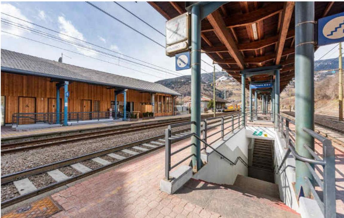
*Bild: Bahnhof Sterzing/Pfitsch - Architektonische Barrieren - Nur ein Treppenzugang, ausstehende Bodenerhöhung für barrierefreien Ein- und Ausstieg in den Zug, fehlender Aufzug, kein Treppenlift, fehlende taktile und optische Bodenleitsystem, ...*
